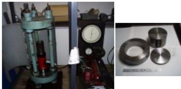
図4 プレス機械と大型試料用ピストン
