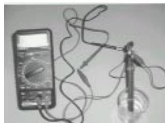
図2 鉛筆電池の起電力を測定する
