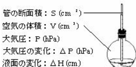
図1 水気圧計の模式図
