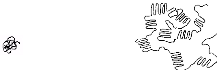
シス型 天然ゴム トランス型 グッタペルカ（天然樹脂） 図1-2 ポリイソプレンの高分子鎖の模式図
