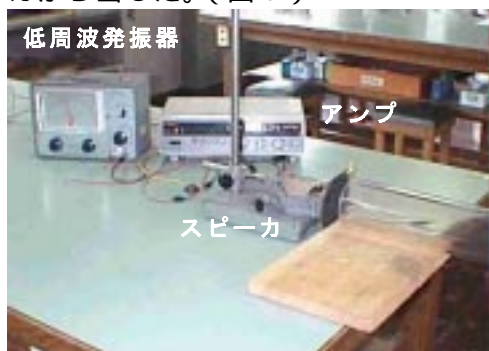
図6 低周波発振器の音をアンプで増幅
