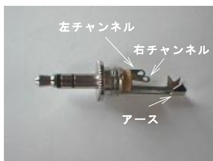
図10 ステレオピンジャックの端子
