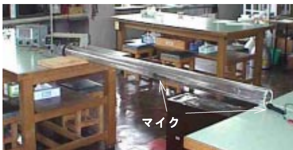
図7 アクリル管での共鳴装置とマイク
