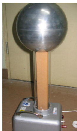
図2 静電高圧発生装置
