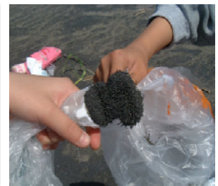
図4 尻別川河口での砂鉄の採集 右：磁石についた砂鉄
