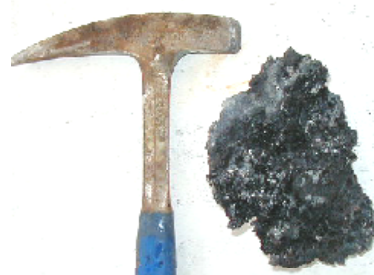
図10 生成したケラ（鋼）約1.5kg
