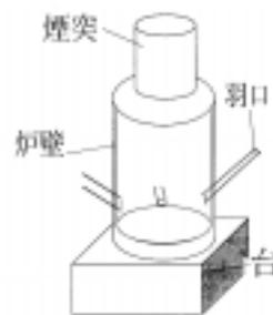
図1 七輪たたら炉の模式図
