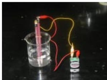
図7 電池の充電による鉛筆電池づくりの様子
