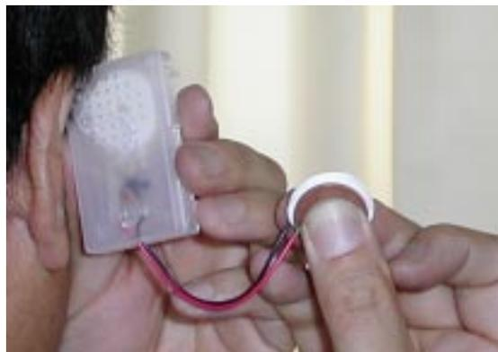
図1 11円電池による電子メロディ音の確認
