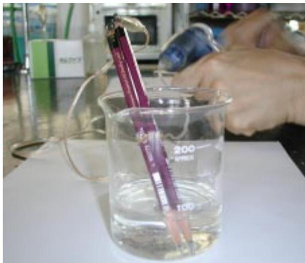
図5 手回し発電機の充電による鉛筆電池づくりの様子
