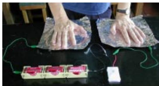
図8 人間の電気電導性を調べる実験
