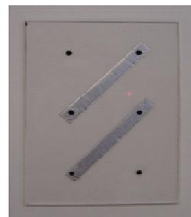
図4 アルミニウムテープを貼ったプラスチック板
