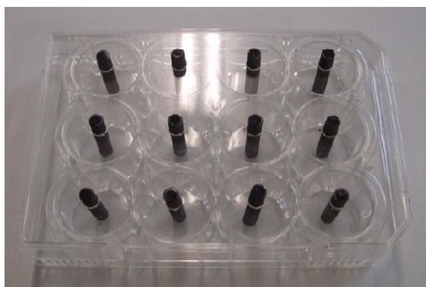
図 1 セルプレートのふたに穴を開け炭素棒を差し込む
