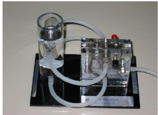
図3 15W電気分解器
