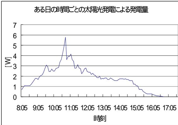
図10 太陽光発電による発電量の時間変化
