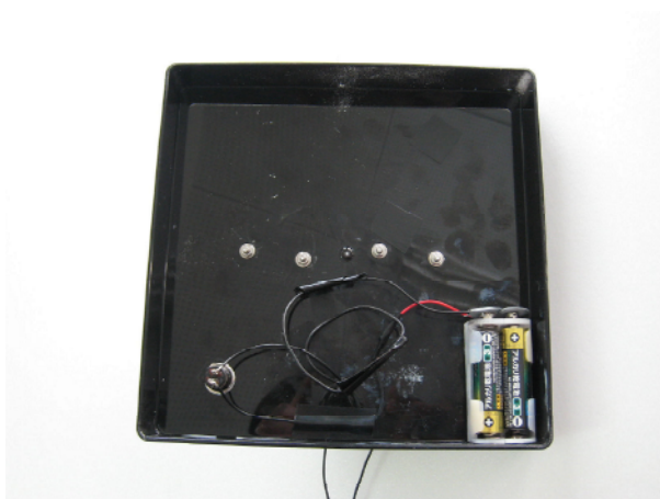
図6 電池ボックスの取り付け
