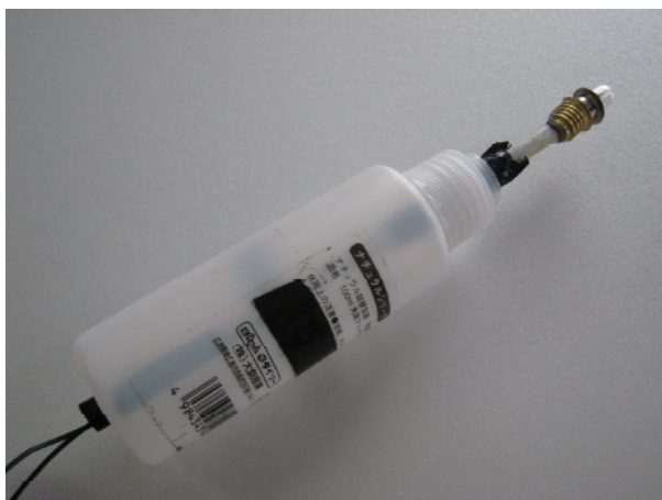
図5 天球儀の光源部分
