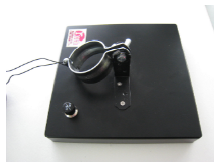
図4 台座への金具の取り付け
