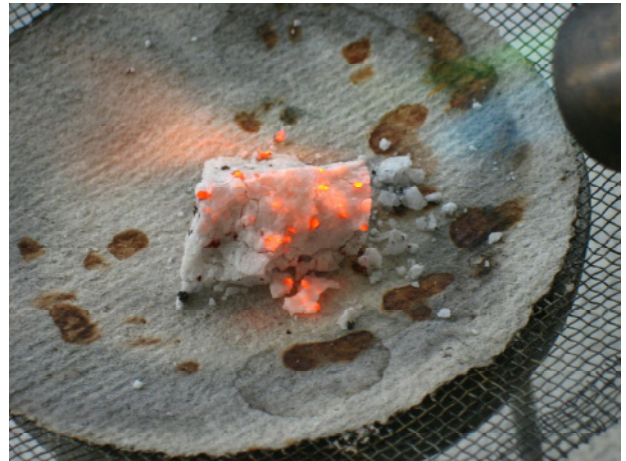
図14 加熱・冷却で崩壊する花崗岩
