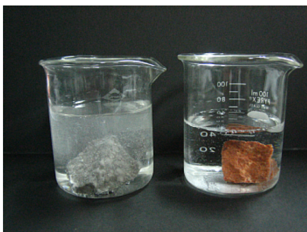
図13 左：酸と反応して発泡する石灰岩 右：発泡しないチャート
