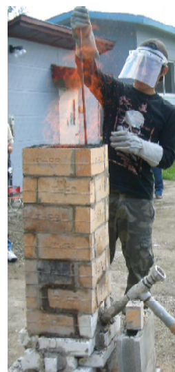
図3 鋼鉄棒で炉の上部の温度を測定し、四隅を突く
