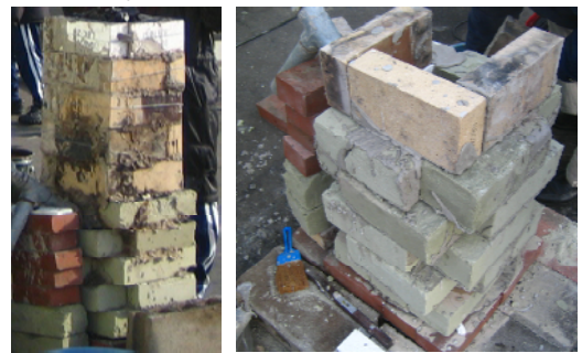
図13 レンガ型によるオリビンレンガ炉
