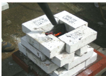
図1 炉内に炭の層をつくり、断熱を行う。
