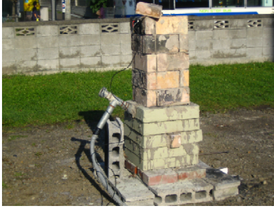
図10 炉の全景（上部に温度計を設置）
