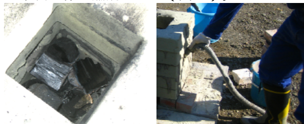
図9 炭の層を炉の中につくる
