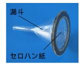
図2 漏斗とセロハ ン紙を接着したゴム板
