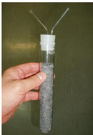
図7 シリコン粒とガラス管を差し込む
