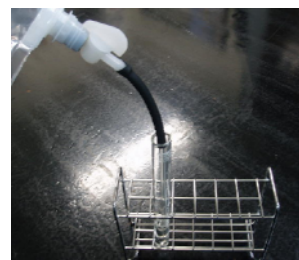
図10 気体をフェノールフタレイン溶液に吹き込む
