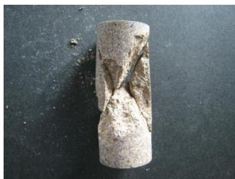
図9 破壊された岩石試料
