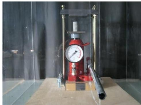
図5 簡易型一軸圧縮試験装置
