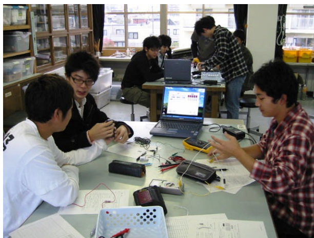
図2 コンデンサーとコイルのリアクタンス測定の様子
