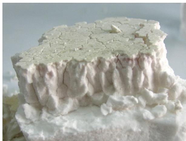
図11 片栗粉で作った“柱状節理”
