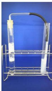
図 4 炭酸水素ナトリウムとフマル酸水溶液による二酸化炭素の発生
