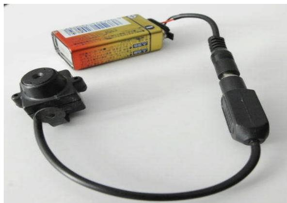
図1 超小型CMOSワイヤレスカメラ
