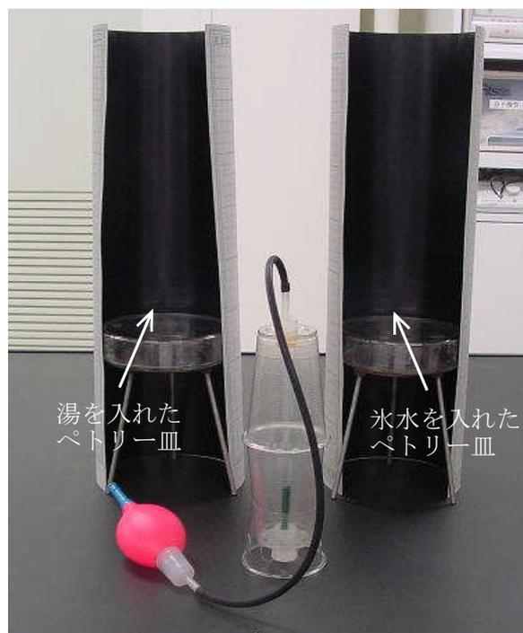
図9 黒色の工作用紙をペトリー皿を囲むようにして立てる
