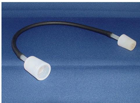
図2 シリコン栓とゴム管の接続
