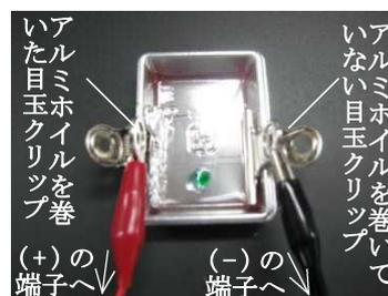
図12 目玉クリップの接続
