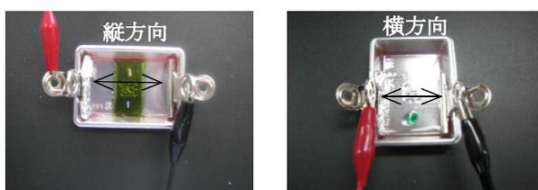
a 酸・アルカリの電気泳動      b 塩化銅水溶液の電気泳動
