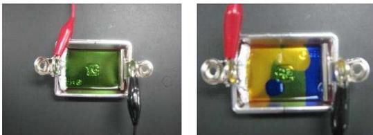
図2 BTB溶液を混ぜた寒天と酸・アルカリの電気泳動の様子
