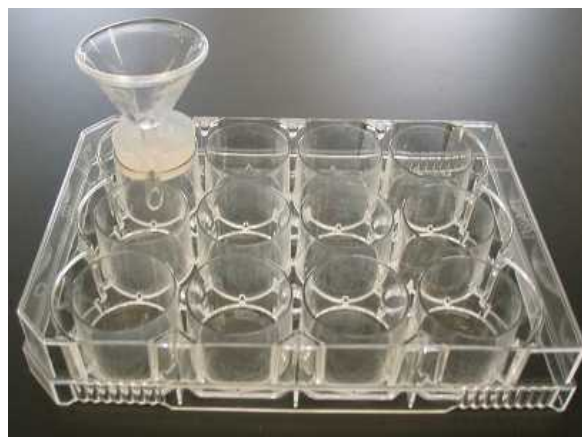
図6 シリコン栓をはめ込んだセルプレート
