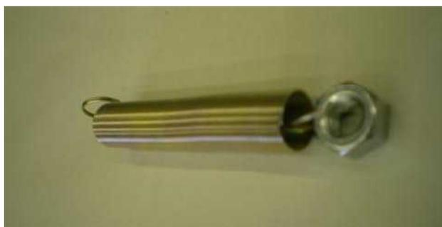
図3 接着面を加工したばね
