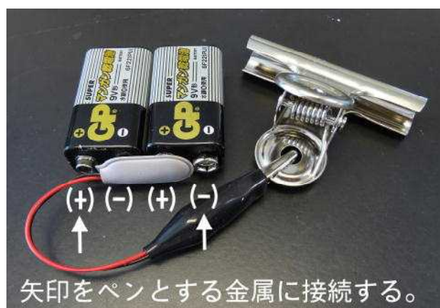
図6 お絵描き用電気ペンの電池のつなぎ方
