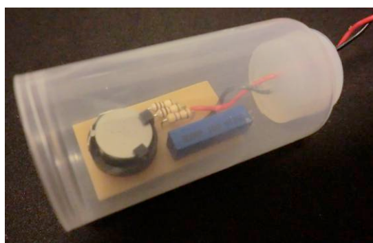
図2 空気電池式酸素センサー
