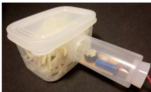
図7 植物の呼吸用実験装置
