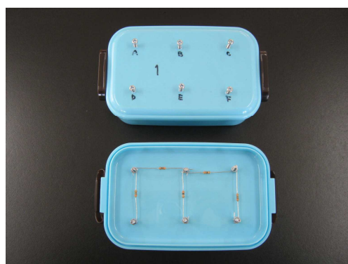
図1 抵抗ブラックボックスの構造例
