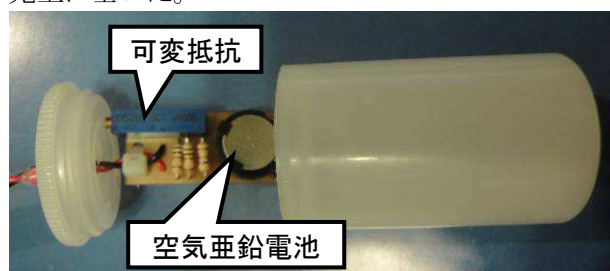
図1 使用した酸素センサー
