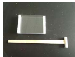
図5 完成した容器と押し固める棒
