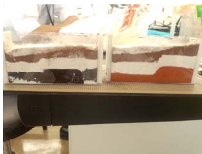
図2 スライム（右）、羊糞（左）を一番下の層にした地層モデル
