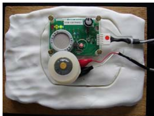
図 1 粘土上に固定した、二酸化炭素センサー（上）と酸素センサー（下）
