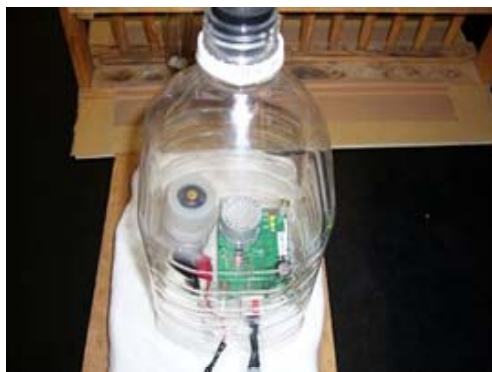
図2 半分に切ったペットボトル（2L）をかぶせたセンサー
