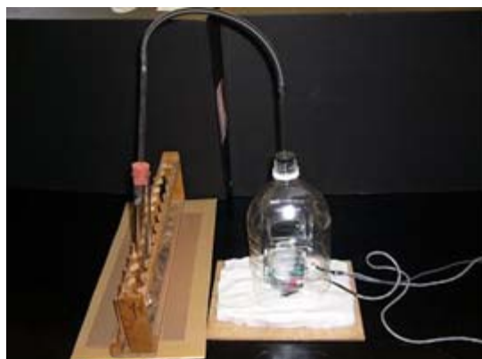
図3 気体を発生させる試験管との接続
