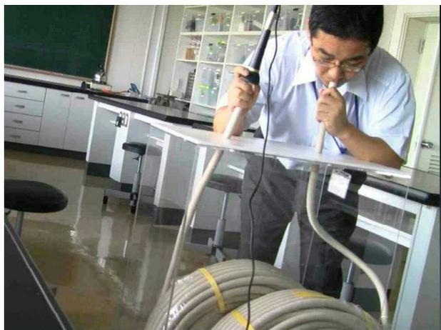
図4 長い管を用いて100m先の自分の声を聞く
