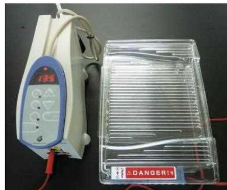
図7 電気泳動装置
