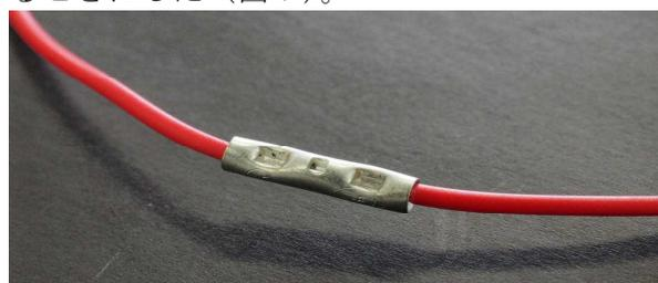
図7 圧着端子で接続した様子
