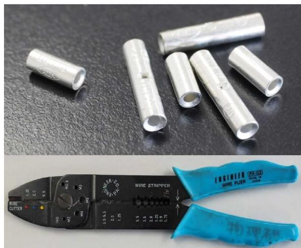
図6 圧着端子と電工ペンチ
