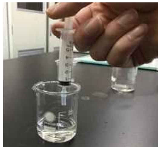
図2 ビュレットに接続するシリンジで試薬を吸い取る様子
