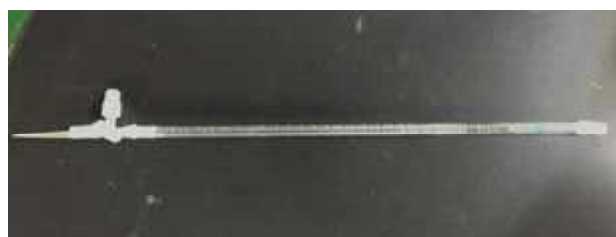
図1 プラスチック製マイクロビュレットを用いた中和滴定の装置
