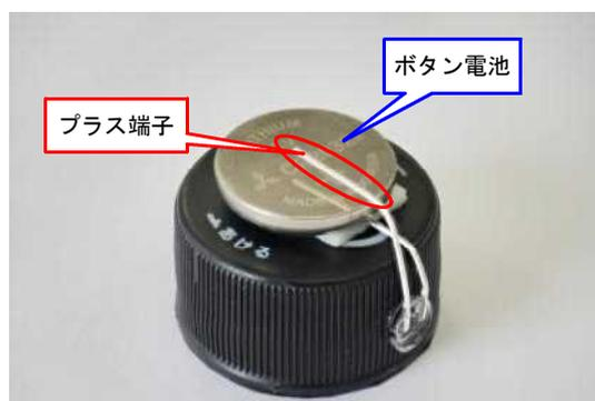
図3 LEDのプラス端子を曲げた様子
