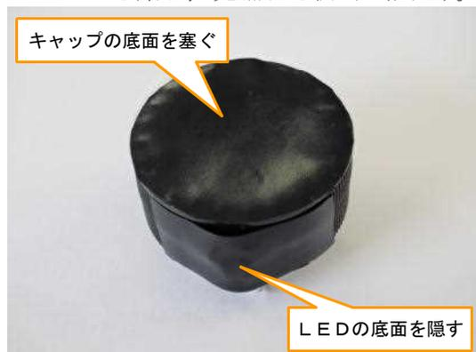
図4 キャップ底面の様子
