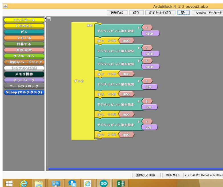
図4 赤・黄・緑のLEDが点灯・消灯するプログラミング
