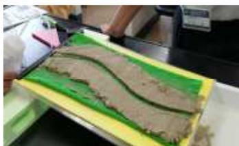
図1 流れる水の働き実験キット
