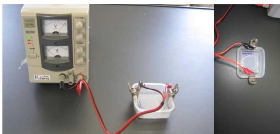
図11 電源装置による電気泳動の様子
