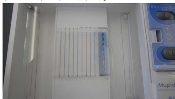
図7 ゲルを電気泳動装置にセッティングした様子
