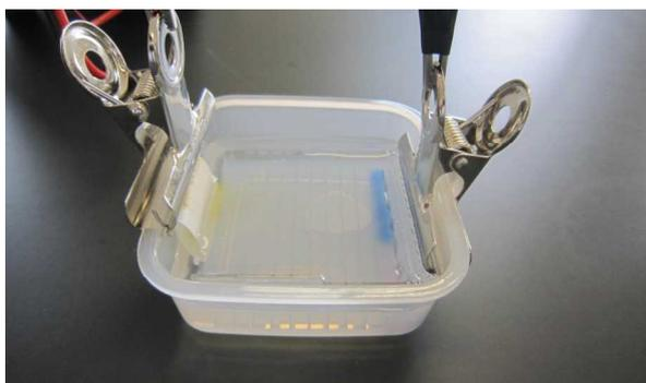
図16 陽極をろ紙にしたときの電気泳動の様子
