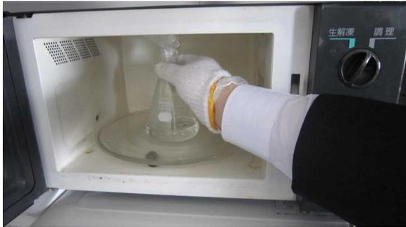
図1 電子レンジによるアガロースゲルの溶解
