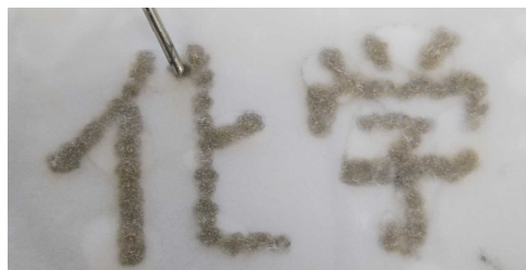
図 5 硝酸銀水溶液を浸したろ紙に電極を接触させて析出した銀で書いた文字
