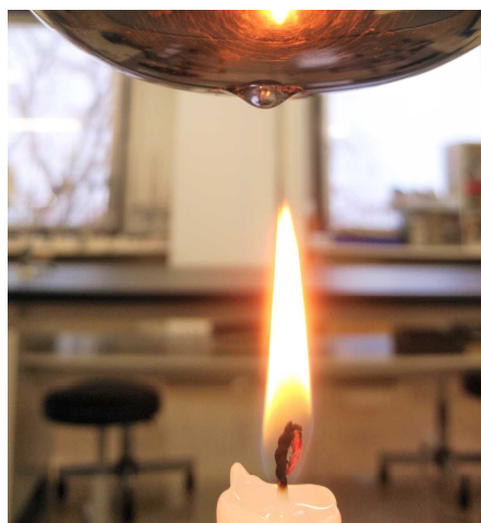
図1 寒剤の入った容器で炎から生じた水蒸気を凝縮させる
