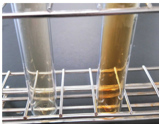
図 7 一酸化窒素が酸化して赤褐色になることを利用した酸素濃度の比較 (左) 空気 (右) 酸素のみ
