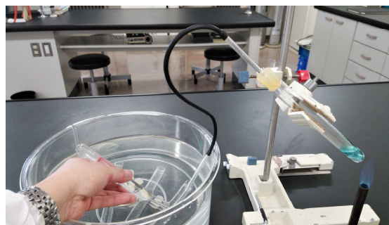
図 6 銅と硝酸を反応させて一酸化窒素を発生させて捕集する
