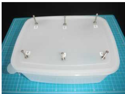
図3 6本のビスを蓋に固定する
