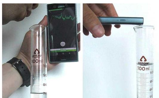
図2 実験風景（左：管の縁を吹いたときの音の振動数の測定，右：管口付近に測定した振動数の音を近づけ共鳴を確認）
