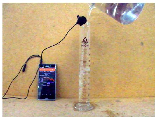
図4 100mLメスシリンダーに水を注ぐ実験風景
