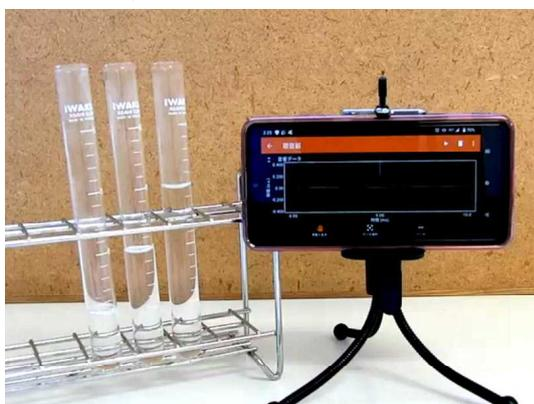
図6 気柱の長さの異なる試験管をスマートフォンのアプリで計測する様子
