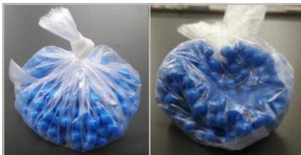
図1 BB弾で作成した粘土の粒子モデル
