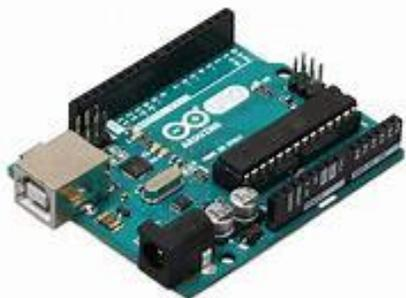
Arduino (アルディーノ) は、プログラミング教育向けのマイコンボードの一つで、ビジュアル型プログラミングソフトのScratch (スクラッチ) で作ったプログラムで動作させることができます。Arduino には、スイッチやブザー等を自由に接続することができ、プログラミングの基礎を学ぶことができます。
