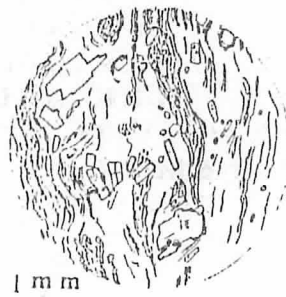
図7 流理構造を示す部分の顕微鏡スケッチ
