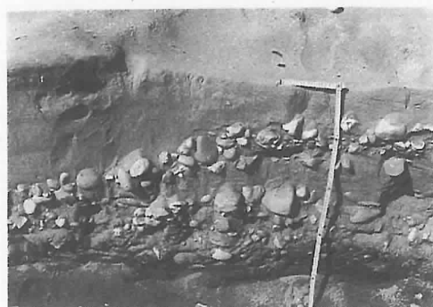
図4 河川堆積物中に認められる堆積構造
