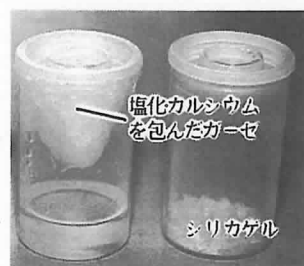
図6 空気中の水分をとらえる方法
