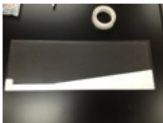
写真1 スチロール板を切り抜くときは、カッターの刃を寝かせて切るのがコツ
