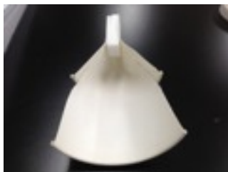
写真5 余ったスチロール板を注ぎ口の上部に付けて土砂供給部分の完成
