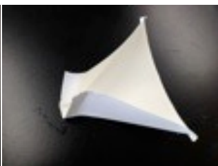
写真3 注ぎ口に、余ったスチロール板を挟んで折り曲げると楽に成形できる
