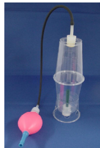
図6 完成した簡易煙発生器
